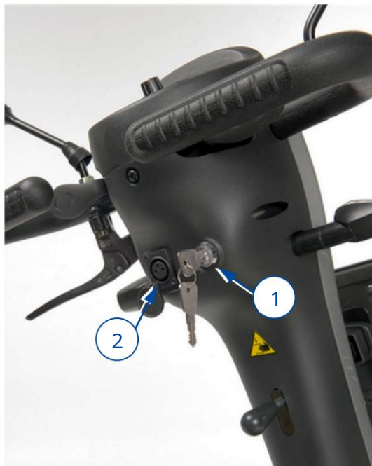
1. Cheie 2. Încărcător de baterie de la rețea
