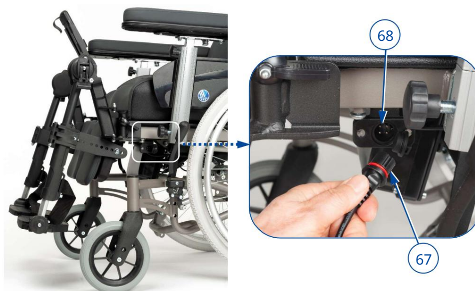
Figure 16 Locația punctului de conectare
