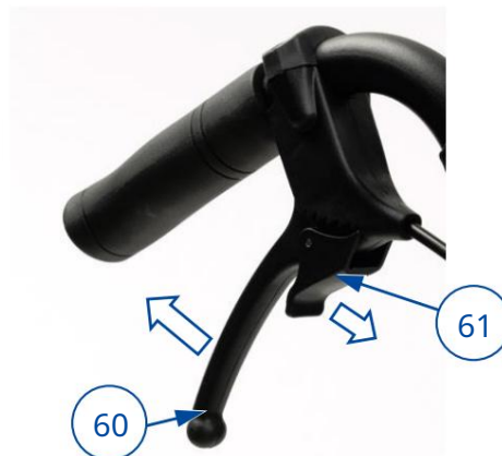
Ilustrația 7 Obsługa hamulców bębnowych
